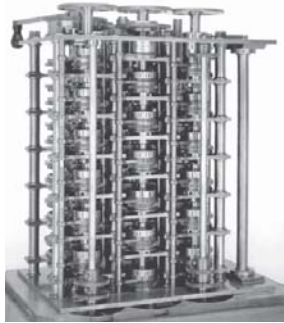
La Macchina analitica (Analytical engine in lingua inglese). La macchina analitica è stato il primo prototipo di un computer meccanico sviluppato per eseguire compiti generici. Il progetto venne sviluppato dal matematico, filosofo e scienziato inglese Charles Babbage (1791–1871).
