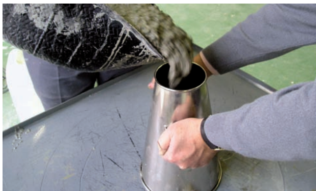
Figura 5.- Ensayo de extensión de flujo.
