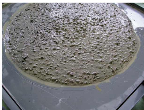
Figura 10.- Ensayo de índice visual de estabilidad (valor índice = 1'5).
