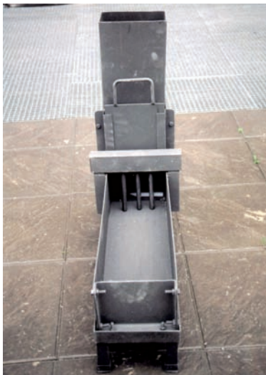
Figura 7.- Ensayo de la caja en L.
