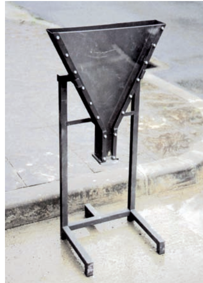
Figura 6.- Ensayo del embudo en V.
