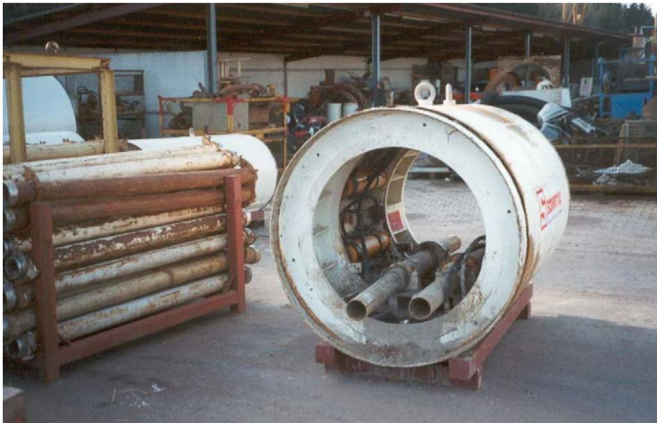
a fin de no deteriorar los tubos. Para este fin se utilizan las estaciones intermedias, que mediante la expansión de los gatos hidráulicos que las componen realizan el empuje de la cabeza y de los tubos anteriores
