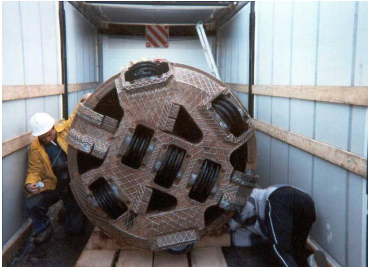
Una vez iniciada la perforación se atraviesa una zona de gravas que no estaba prevista y los discos, en vez de encontrar una pared compacta donde apoyarse y girar, encuentran unas gravas sueltas donde no se produce el giro, quedando estos en posición fija perpendicular al giro de la cabeza, por lo que se produce el choque con las gravas
