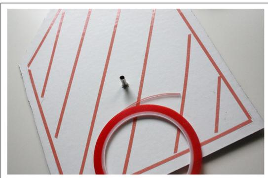
**5.** Auf der **Rückseite** des Hauselements **doppelseitiges Klebeband** anbringen, einen Teil der Schraube als Platzierungshilfe durch das Loch stecken und dann mittig auf die **Holzplatte** kleben.
