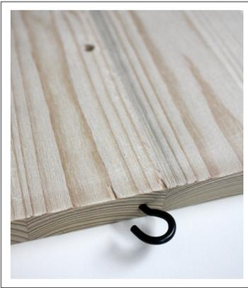
**2.** Dann auf dem unteren Rand mittig ebenfalls ein kleines Loch bohren und den **Schraubhaken** eindrehen. (Der Bohrer sollte dabei natürlich etwas dünner sein als der Haken, damit er beim Eindrehen auch greift ...)
